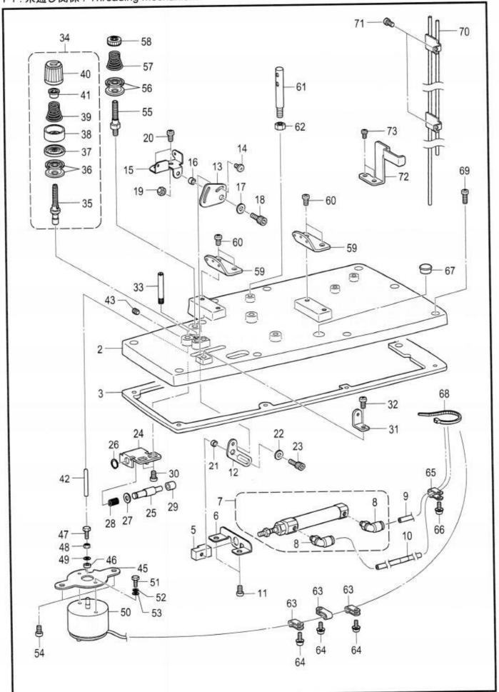
P1. 糸通し関係 / Threading mechanism
