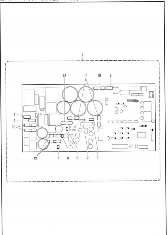
S2. コントロールボックス関係(電源モータ基板)/ Control box mechanism (Power supply motor PCB)
