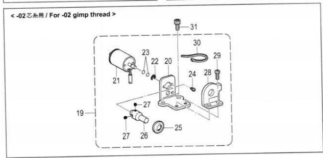
P3. 糸通し関係 / Threading mechanism
