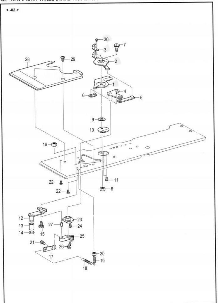
Q2. 糸切り関係 / Thread trimmer mechanism
