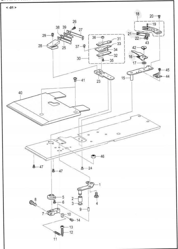
Q1. 糸切り関係 / Thread trimmer mechanism
