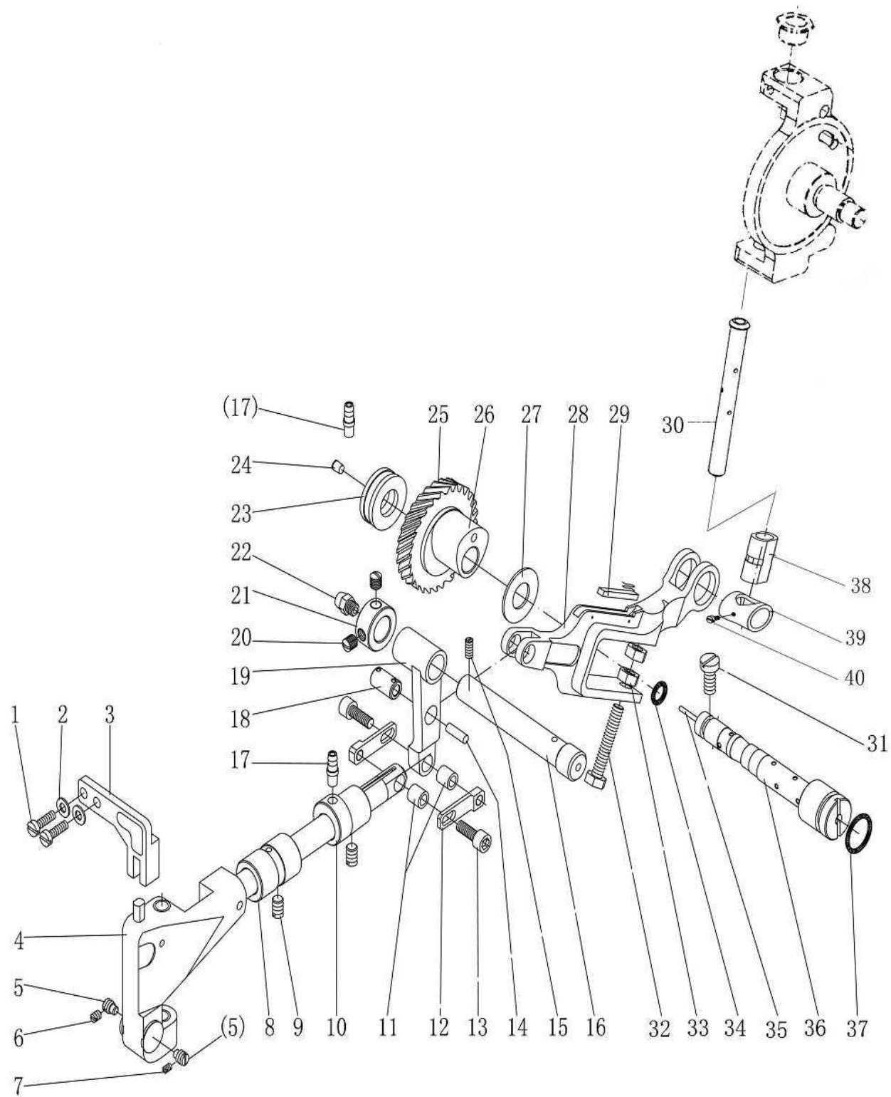
D. Needle bar vibrating parts (一)
