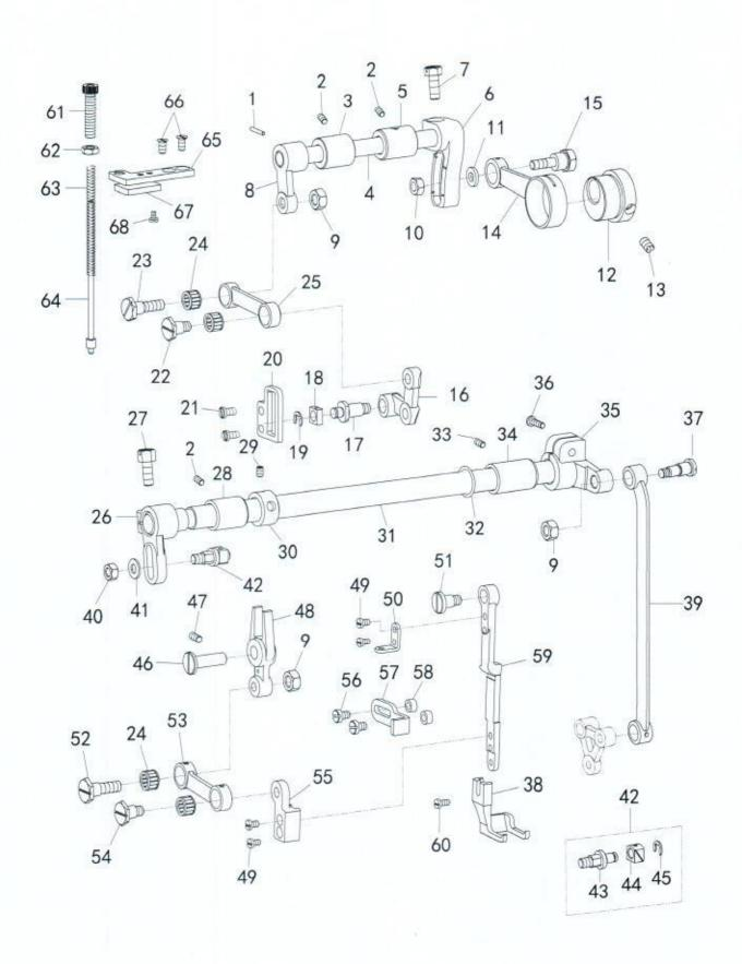
7. 上送料机构/Upper feed mechanism(FOR 2522D、2523D、2524D)
