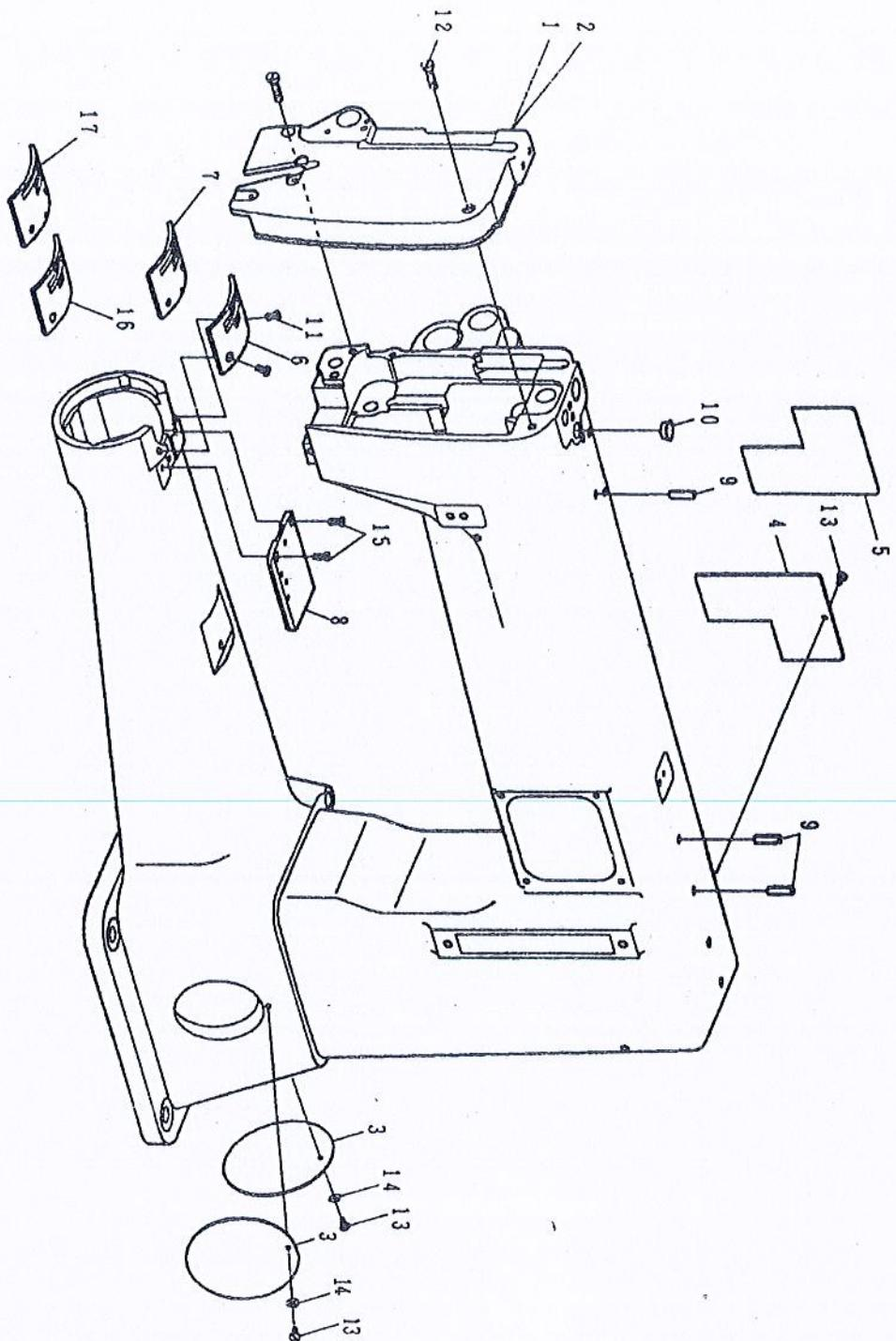
A、机壳、外装机构 FRAME & MISCELLANEOUS COVER COMPONENTS
