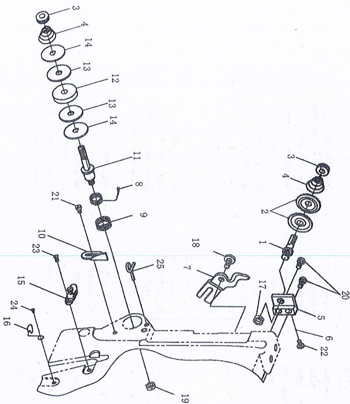
G、夹线器机构 TENSION POST COMPONENTS
