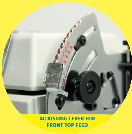
ADJUSTING LEVER FOR FRONT TOP FEED
