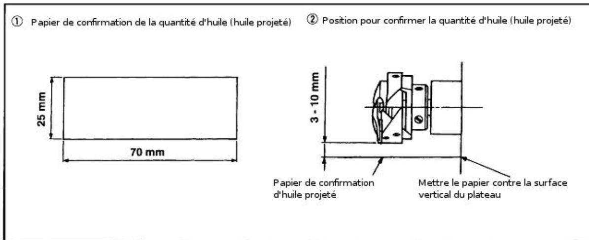
\* Lorsque vous faites la procédure ci-dessous en 2, retirer la plaque glissoire et prendre un soin très attentif à ce que vos doigts ne soit pas en contact avec le crochet.
