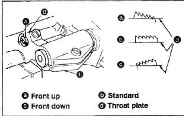
1. La position standard (horizontal) de le griffe est obtenue lorsque le repère A sur l'axe d'entraînement est aligné avec le repère B de l'articulation ①. Le repère B avec un angle de 90° correspond au réglage standard.
