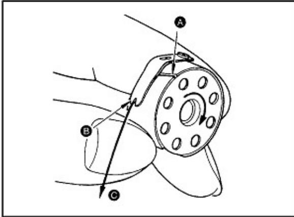
1) Passer le fil à travers la fente A, et tirer le fil en direction de B
