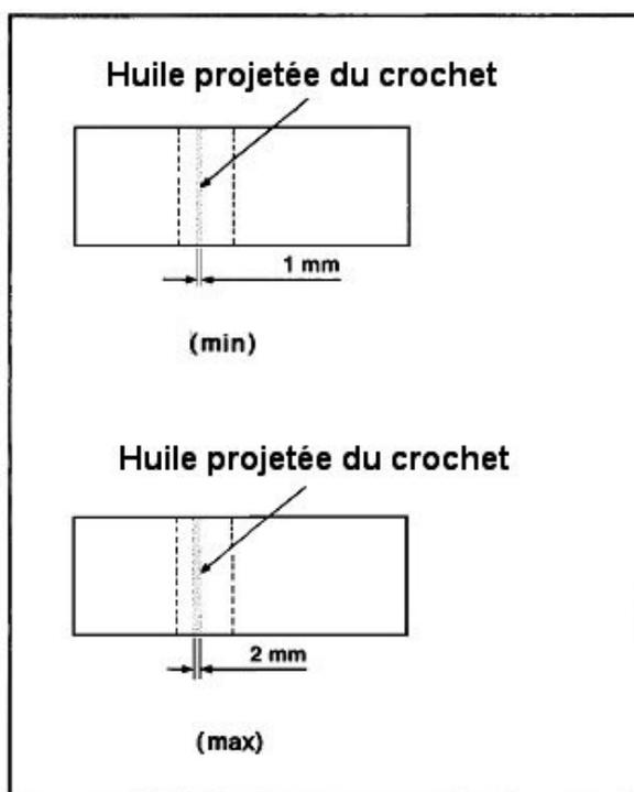
1) La quantité d'huile montrée dans l'exemple de gauche peut être finement réglée en fonction du type de couture. Bien s'assurer de ne pas régler augmenter/diminuer la quantité d'huile du crochet. (Si la quantité est trop faible, le crochet va gripper (le crochet devient chaud). Si la quantité d'huile est trop importante, la production risque d'être tachée par l'huile.
