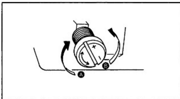
1) Tourner la vis de réglage de quantité d'huile sur l'arbre de crochet en direction du + (vers A) pour augmenter le volume d'huile dans le crochet, et en direction du - (vers B) pour le diminuer.
