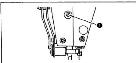
1) Dévisser la vis ❶, et régler la hauteur de la barre de pression ou l'angle du pied presseur.
